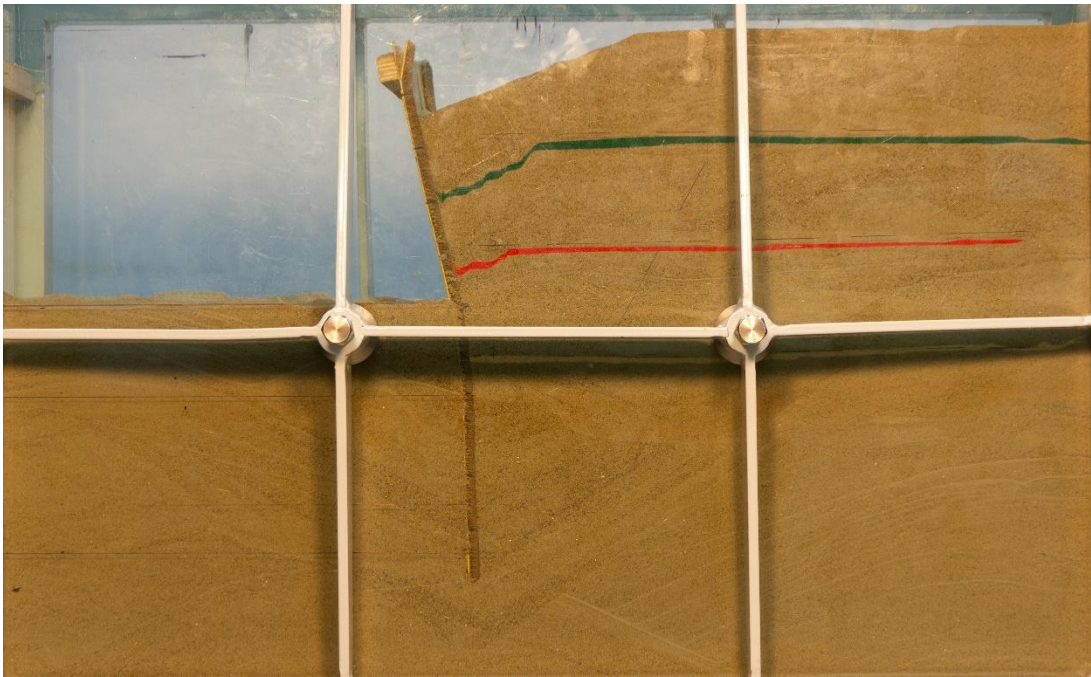
Рисунок 2.2.17 – Деформированная схема, полученная для модели подпорной стенки, работающей по консольной схеме. Опыт №7
