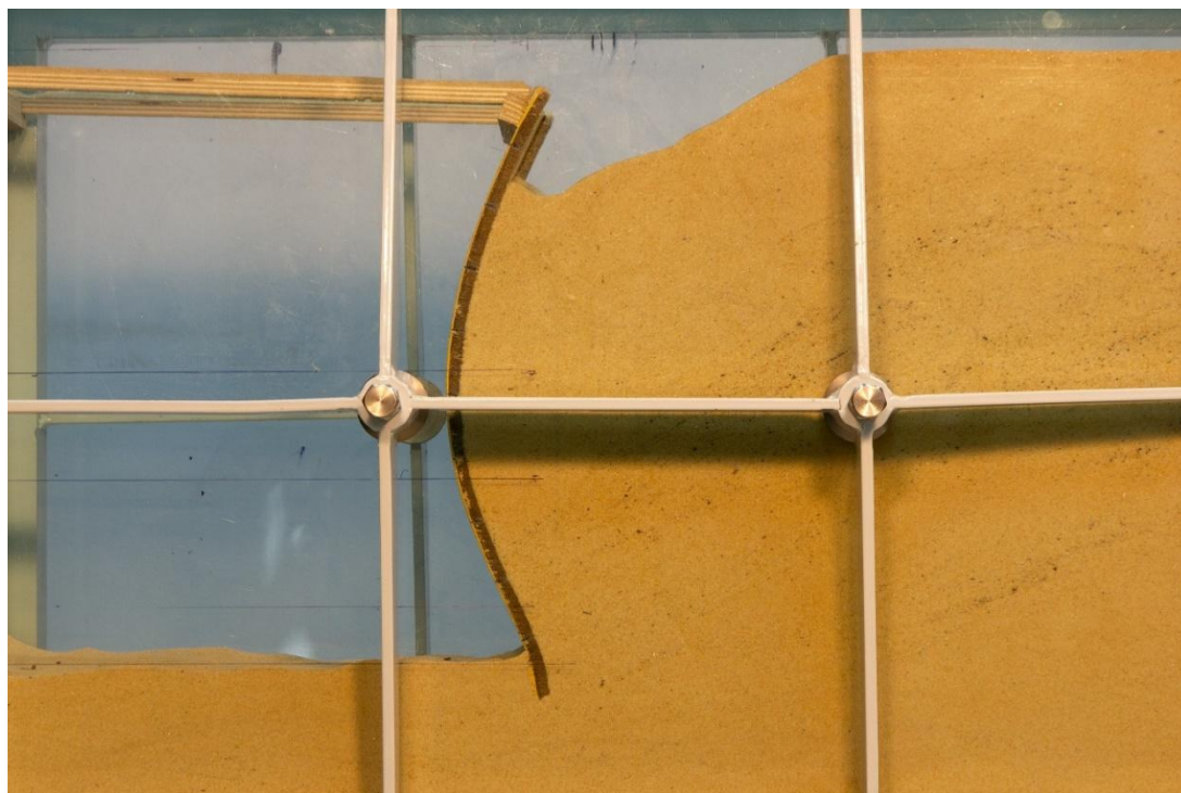
Рисунок 2.2.11 – Лотковый эксперимент. Опыт №6. Деформированная схема
