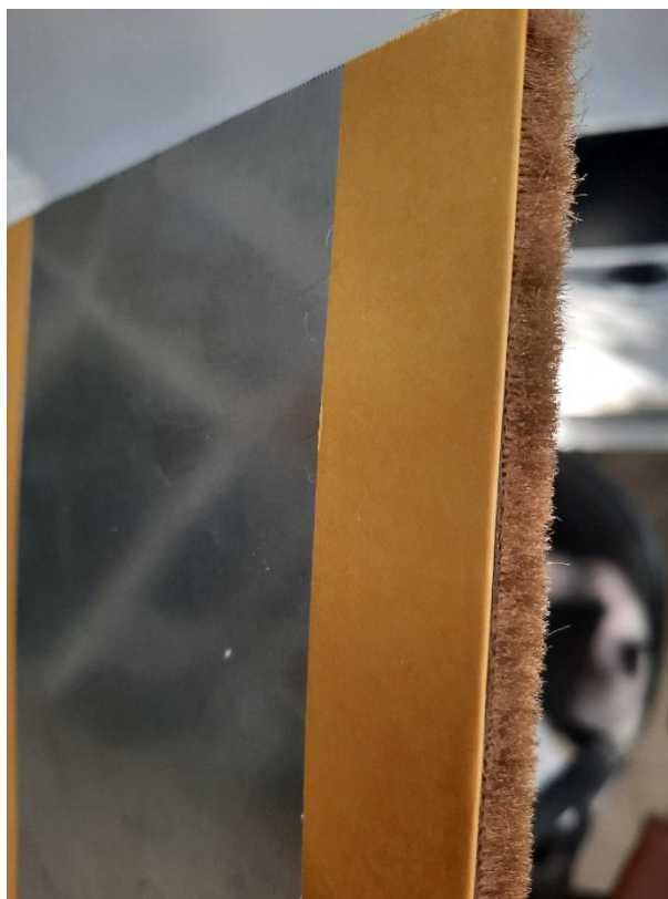
Рисунок 2.1.2 – Буферная лента, наклеенная на край модельной стенки
